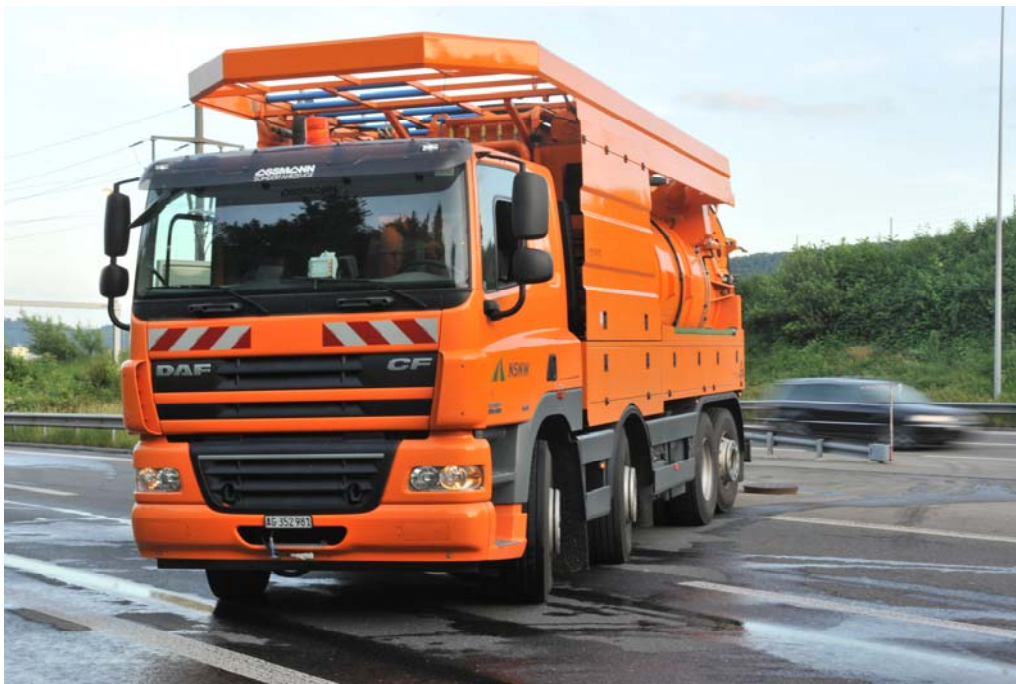
Fahrzeug der Reinigungsgruppe Leistungsfähige Reinigung der Entwässerungsanlagen
